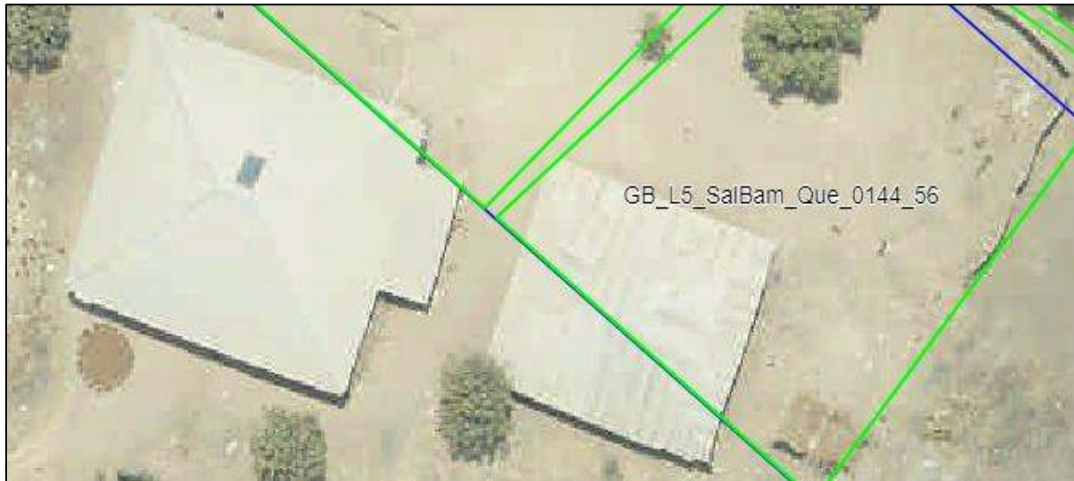
Figura 17 Edifícios no direito de passagem da linha entre Saltinho e Bambadinca
